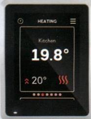
RMU S40 je pokojová jednotka s 2,8" dotykovým displejem a vestavěným snímačem teploty a vlhkosti. Používá se k ovládání a sledování tepelného čerpadla a vnitřní jednotky z jiné místnosti, než kde je samotné čerpadlo. NIBE
