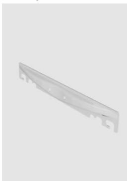
Nový závěs ohřivačů vody s volitelnými upínacími rozměry pro rozteč šroubů ve zdi 300-310 mm, 350-372 mm, 432-468 mm
