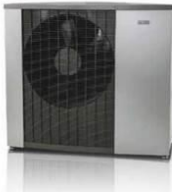
Tepelné čerpadlo vzduch/voda NIBE F2120 s výstupní teplotou až 65^{\circ}\text{C} a 63^{\circ}\text{C} i při venkovní teplotě -25^{\circ}\text{C} . Vyrábí se ve čtyřech výkonových řadách. Zajišťuje i chlazení s minimální výstupní teplotou +7^{\circ}\text{C} (NIBE)
