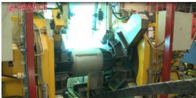
Рис. 2. Автоматическая сборка емкости с кольцевым сварным швом
