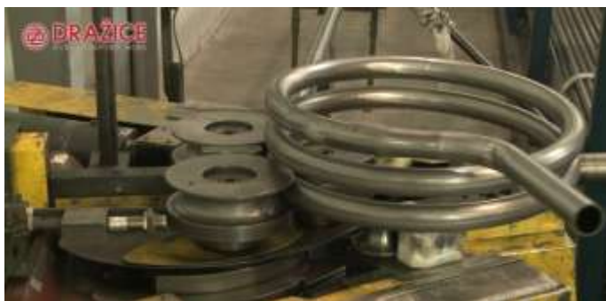
Рис. 1. Свивание трубок под контролем компьютера
