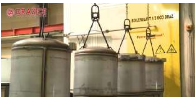
Рис. 4. Предварительная струйно-абразивная обработка
