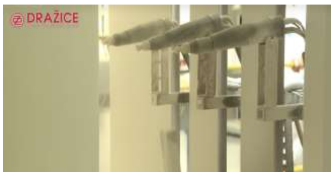
Рис. 6. Нанесение порошкового покрытия электростатическим методом
