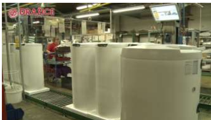
Рис. 7. Водонагреватели перед конечным контролем и упаковкой с заводским номером.
