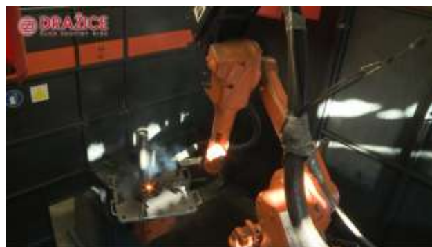
Рис. 5. Роботизированная сварка фланцев
