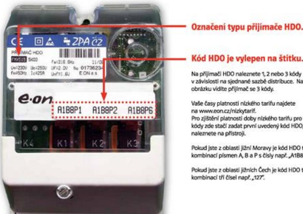
Obrázek 7: Jedna z možností přijímače HDO
