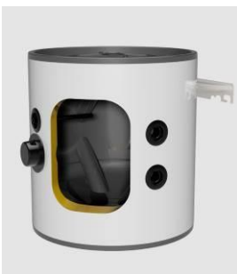
Akumulční nádrž NAD 50 v1 s polyuretanovou izolací (PUR 42 mm) a plechovým lakovaným pláštěm, do které je možné instalovat šroubovací topnou jednotku TJ 6/4“ (DZD).
