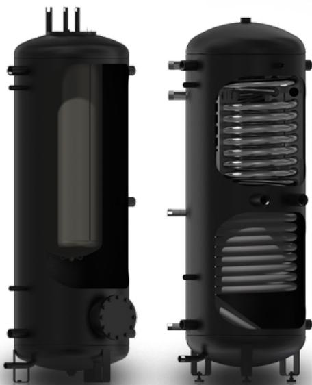
Der Typ NADO und NADOS (mit Brauchwasserbereitung) ermöglicht auch die direkte Erwärmung des Brauchwassers im Edelstahlwellrohr bzw. im emaillierten Innenbehälter oder seine Vorwärmung für einen weiteren Warmwasserbereiter
