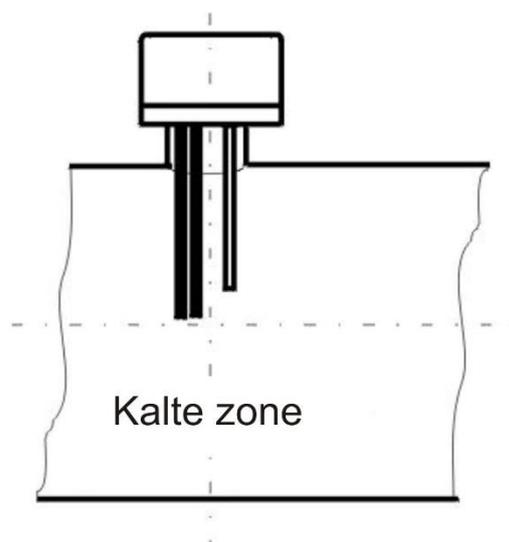
Der eingebaute Flansch ist zu hoch und in umgekehrter Position eingebaut (Schutzabdeckung oben)
