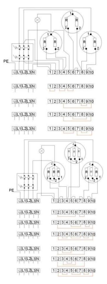
**3** kW 1 PE - N AC 230 V / 50 Hz
